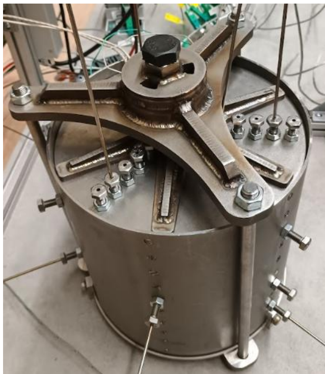
Obr. 5 Sestavení demonstrátoru bez tepelněizolačního pláště
